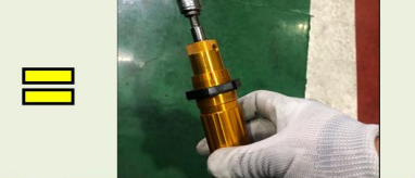
トルクを2 Nmに設定 ※トルクは実機に手N増しを行い設定
